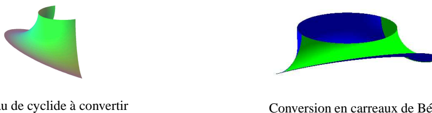
FIG. 5 – Problème de l'algorithme de Pratt amélioré pour effectuer certaine conversion d'un morceau de cyclide de Dupin en un carreau de Bézier Rationnel biquadrique.
