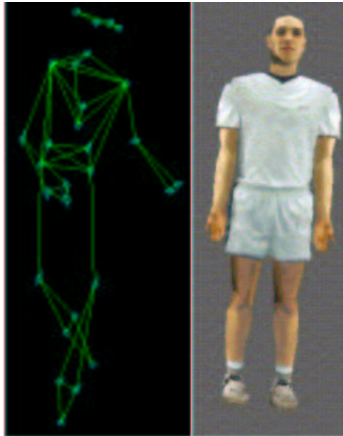
Figure 2 : Placement des marqueurs infrarouges et humanoïde synthétique utilisé lors des expérimentations.
