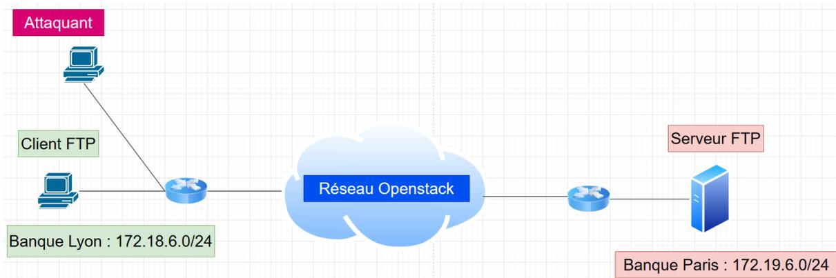
On va vouloir mettre en place l'architecture ci-dessus. Il s'agit de simuler les échanges entre deux banques (une à Lyon et une à Paris) reliées par un réseau de routeurs.
