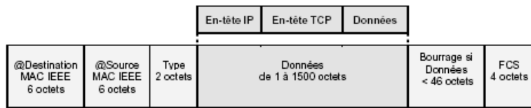
Format de la trame Ethernet v2 et encapsulation IP.
