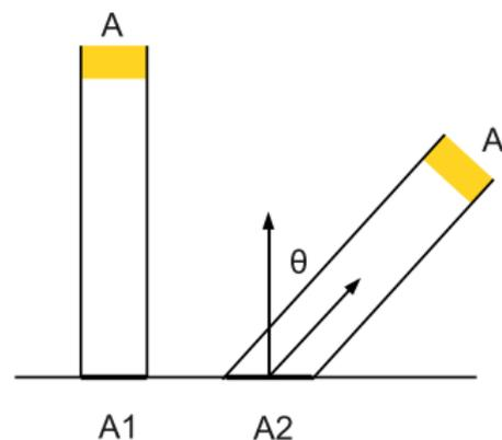
$$E_1 = \frac{\Phi}{A_1} \text{ avec } A_1 = A, \text{ donc } E_1 = \frac{\Phi}{A}$$
