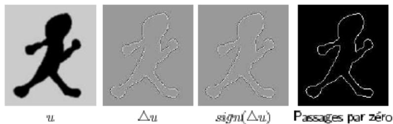
Figure 31 : Démarche de détection de contour par le zero crossing
